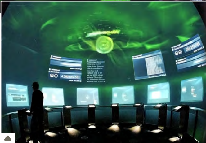
12m 360° Kuppelprojektionssystem mit 8 Multimediaterminals, Multi-layer-Animation, Multimediainhalten und Echtzeitinformation (VW AG)
